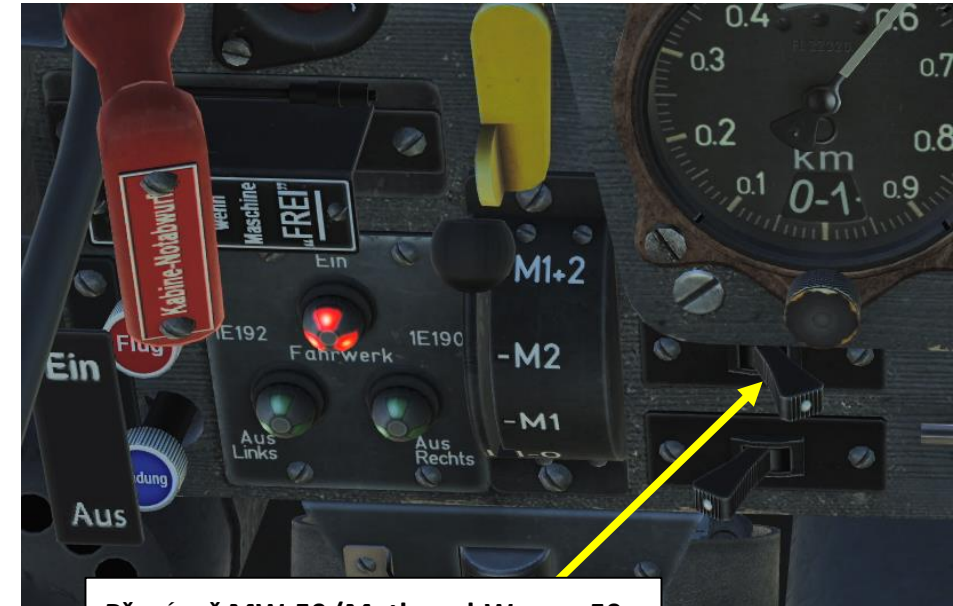
Přepínač MW-50 (Methanol-Wasser 50 - vstřikování vody a methanolu) Vlevo = Vypnuto Vpravo = Zapnuto
