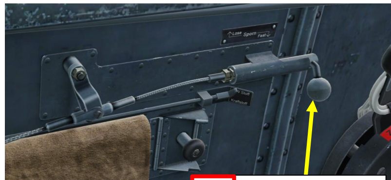
2 Zablockované zadní kolo (poloha ve tvaru "L")
