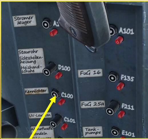
C100 Vypínač napájení navigačních světel (Kennlichter)
